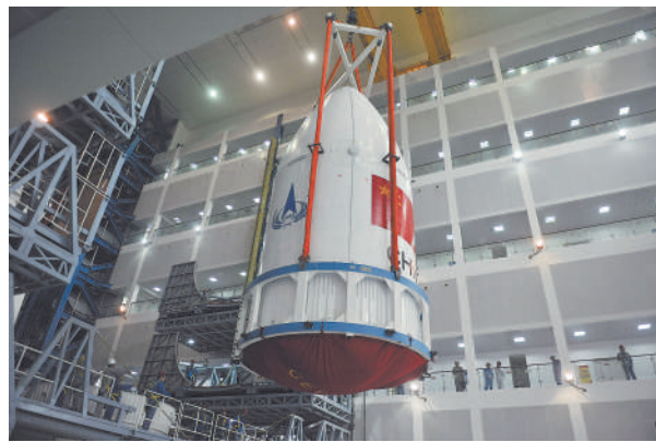
星箭组合体吊装。 周雅露/摄
