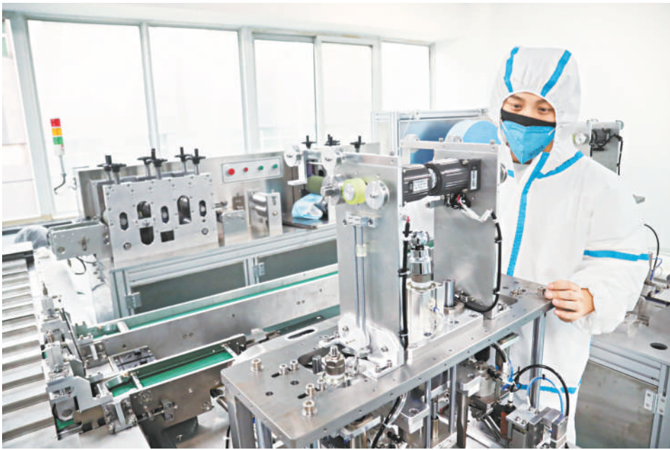
▲技术人员正在安装调试口罩生产线。原梓峰/摄
