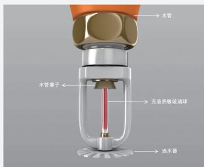
消防喷淋的结构也相对简单,主要是由洒水器、充液的热敏玻璃球、水管塞子和水管组成。其中最为重要的就是中间的热敏玻璃球了,热敏玻璃球中存放着煤油、乙醚等溶液,五颜六色的非常好看。但是别被这五颜六色所迷惑了,当喷淋头周边环境温度达到预设动作温度时(火灾),玻璃球自动破裂喷水灭火,其中各类颜色动作温度为:红色68℃,黄色79℃,绿色93℃,蓝色141℃,一般也就会用到这几种,而红色则是我们生活中最常用的喷淋头。
