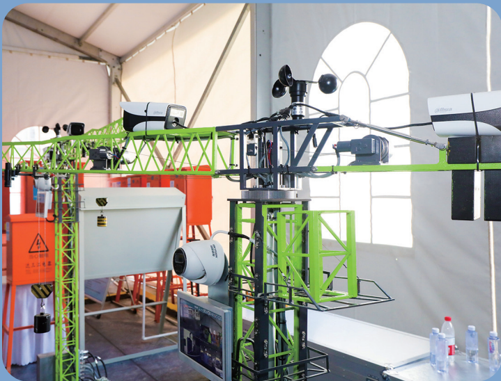
智慧塔吊监控系统
