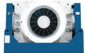
大推力振动台系统可以在实验室模拟产品在实际工作环境中受到的力学环境,是导弹武器、卫星、运载火箭、空间站、高铁、汽车、家电、高压电设备
