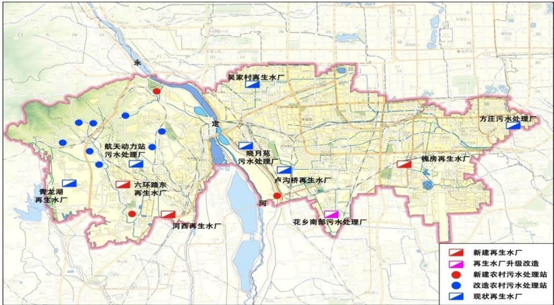
图 6.2 丰台区“十三五”时期污水处理设施建设位置规划图
