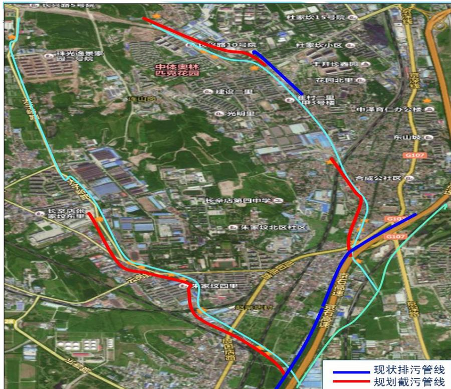
图 6.8 九子河、蟒牛河截污工程示意图
